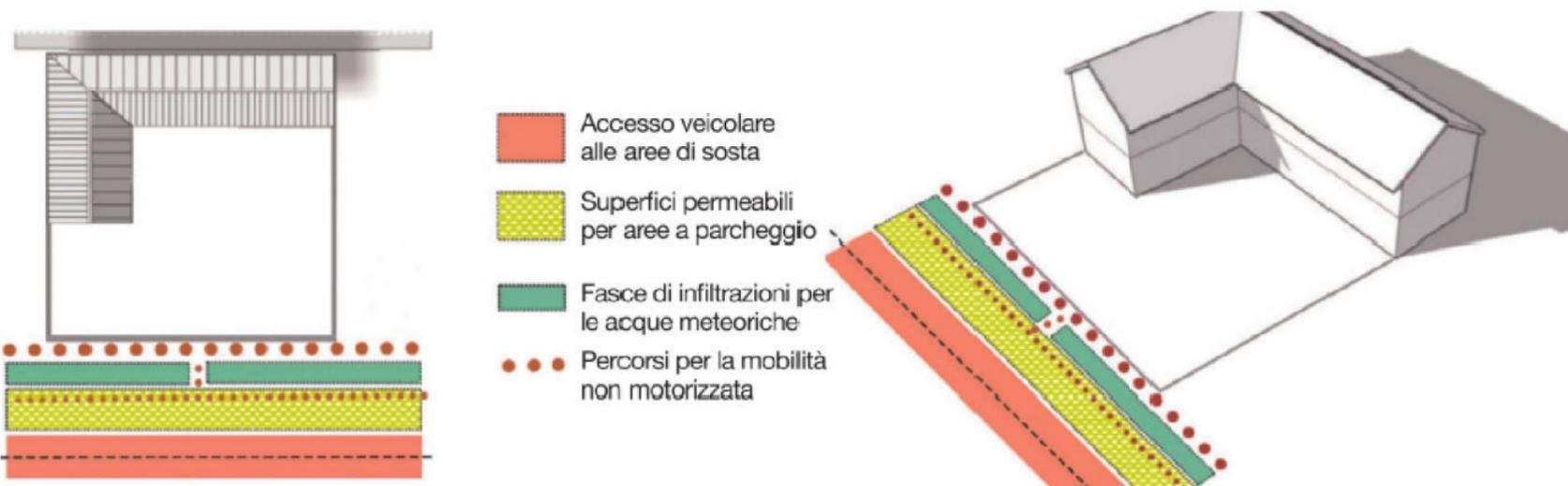
**Gestione dei deflussi meteorici nelle aree pertinenti a parcheggio**, utilizzando specifiche soluzioni di pavimentazione al fine di limitare la mineralizzazione dei suoli in corrispondenza delle superfici carrabili.
