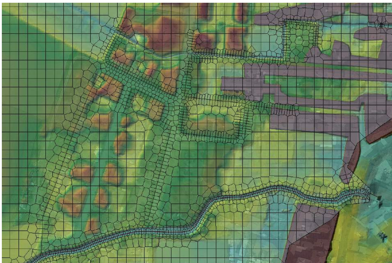
Zona centrale via Carando – Festa – Gamerj – Rejnaud e Stobbia: sovrapposizione mesh di calcolo, dtm in falso colore e foto aerea Google satellite.
