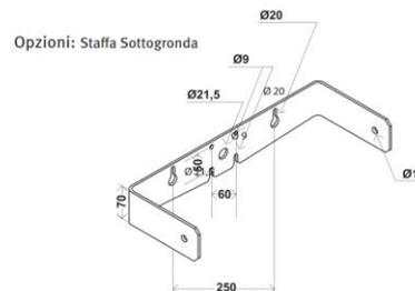
La staffa di fissaggio sottogronda è stata appositamente studiata per montaggio sulle facciate. Risulta facile da installare grazie alle 4 viti M8.
