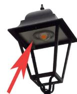
Retrofit sulle lanterne artistiche tramite piastra tipo Arty della M.i.LED (o equivalente) con temperatura di colore 2'200 K dotata di alimentatore elettronico per la riduzione del flusso luminoso in misura pari al 30% dalle ore 24 allo spegnimento
